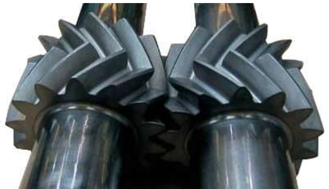
Engranajes Chevron (doble helicoidal) Herringbone gears 人字齿
